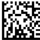
Kuva 2: Esimerkki GS1 DataMatrix -viivakoodista, jossa tietosisältö on GS1-standardin mukaisessa muodossa.
