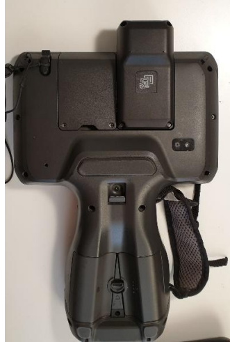
Kuva 8 Trimble TSC7 -maastotietokone viivakoodinlukijalla
